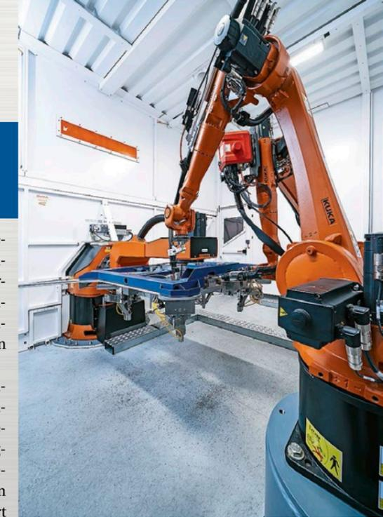
Ein vollautomatisierter Schweißroboter von Kuka.
