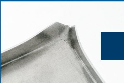
Vorgekantetes Bauteil mit Sonderwerkzeug der Matrizengröße V8 und V12
