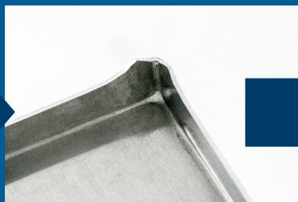
Bauteil nach dem Eckenformen mit zum ziehen benötigtem überschüssigem Material
