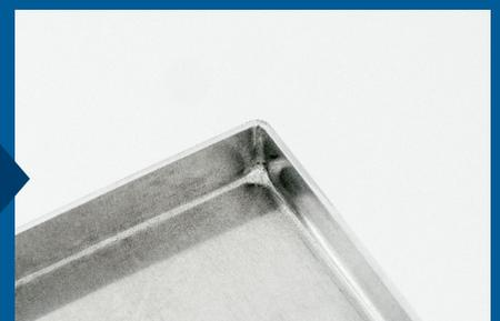
Fertiges Bauteil, überschüssiges Material wurde abgeschert
