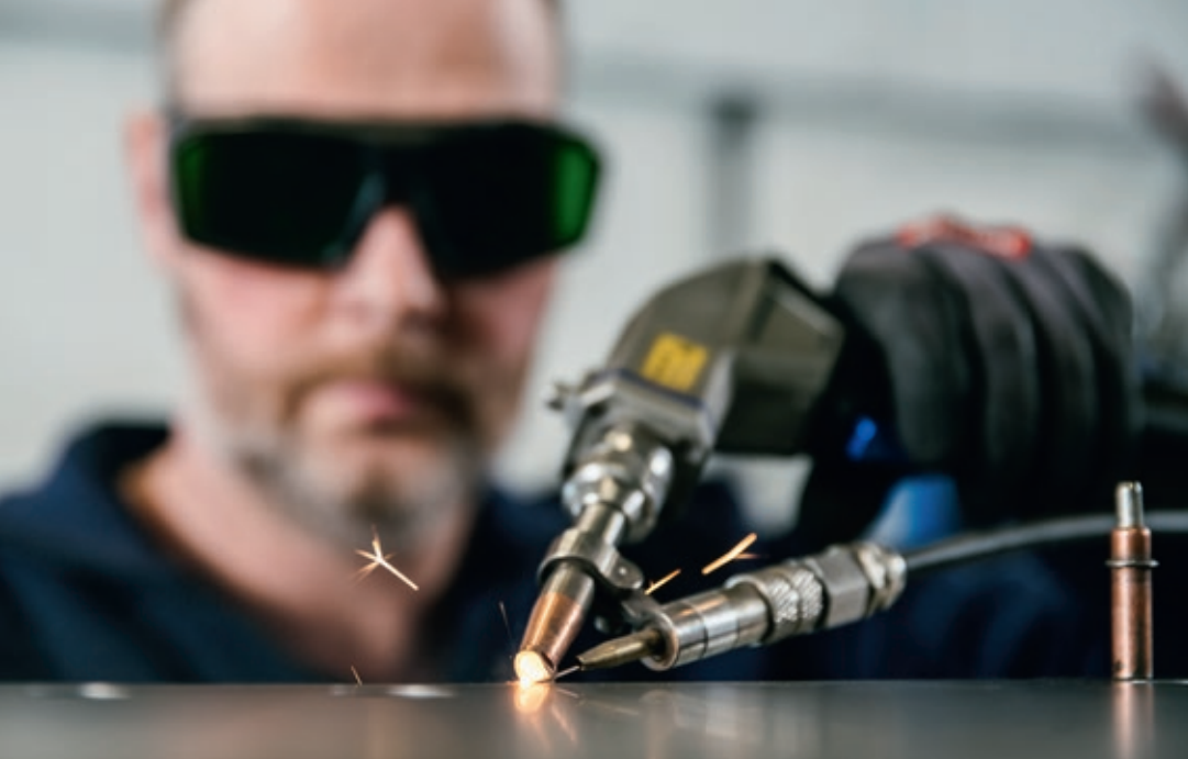
Neues Schweißverfahren: Beim manuellen 3D-Laserschweißen entstehen optisch ansprechende und schmale Schweißnähte.
